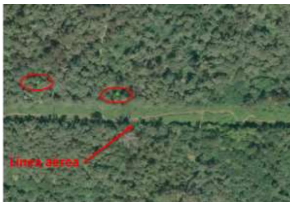
Figura 15.- Identificación de árboles enfermos próximos a la red mediante procesado de imagen de satélite
