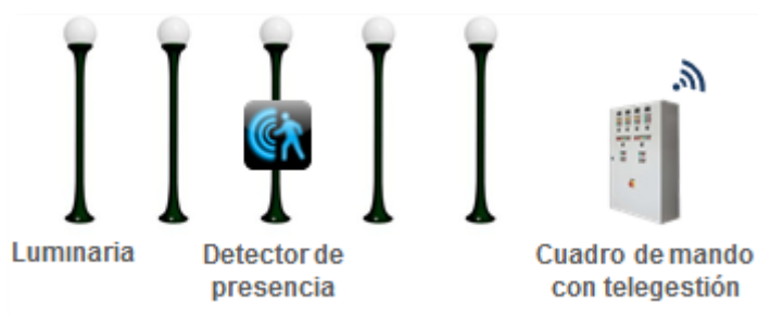
Ilustración 40: Ilustración de luminarias con telegestión por cuadro de mando y detección de presencia. Elaboración propia.
