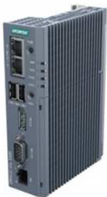
Nodo principal: SIEMENS SEMATIC IOT2050
