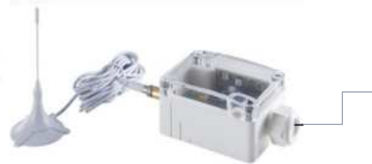
Receptor inalámbrico para emisor de pulsos de contador de agua general. Comunica a la instalación a través de Modbus RTU (Puerto RS485 del IOT2040)
