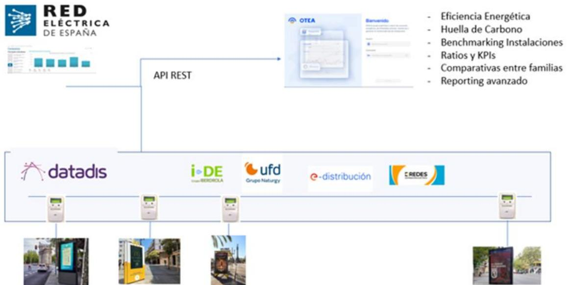
No se requiere de hardware adicional al existir una gran cantidad de contadores inteligentes. El software es escalable y permitirá en un futuro añadir otras tecnologías sobre equipos sin contador con el fin de realizar órdenes en remoto.
