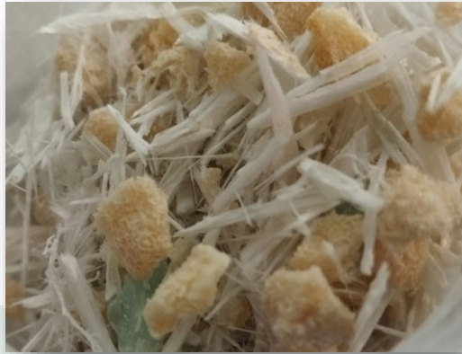
Imagen 9.- Triturado de palas.
