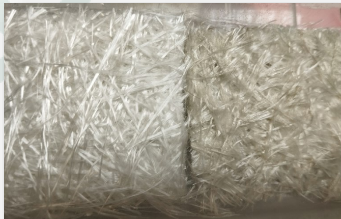
Imagen 10.- Fibras y resina generados tras la solvólisis.
